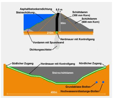
dagegen Staumauern besser geeignet). Zum Nachweis zur Standsicherheit eines Staudammes muss u.a. die "Sicherheit gegen Böschungsbruch" berechnet werden.
